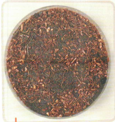
1. Mélange de copeaux de cuivre et d'émail de fer.
